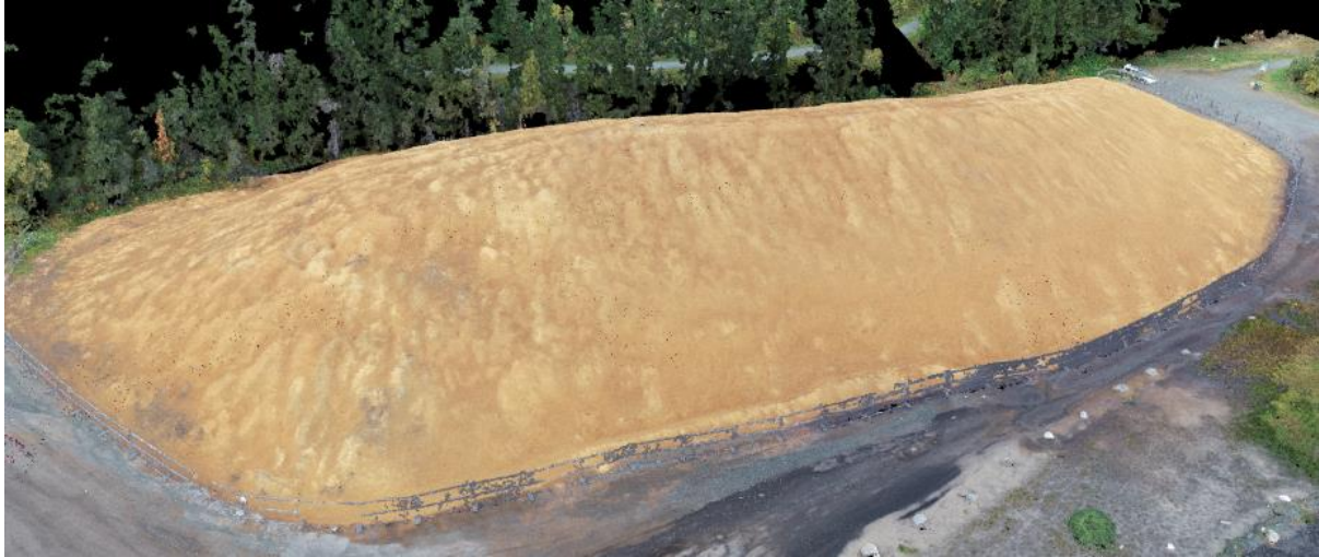
Figur 4: 3D modell generert ved bruk av Pix4D. Foto: Sondre Auganæs
