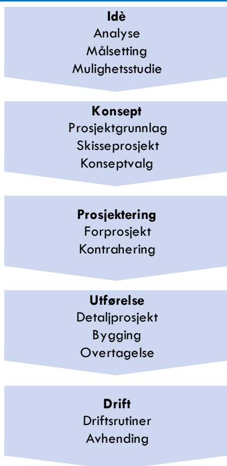
Figur 2-2: Illustrasjon av hovedfaser i byggeprosess
