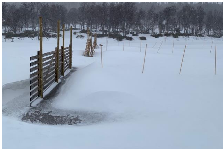
Figur 10: Viser den oppsamlede snøen bak snøskjermene i Vålådalen, med snøskjerm 3 med 30 % porøsitet nærmest i bildet.
