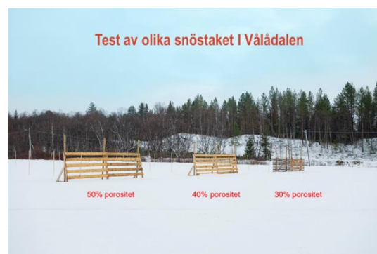
Figur 9: Utplassering av snøgjerder i Vålådalen, der gjerdene ble festet i trestolper som ble slått ned i bakken.
