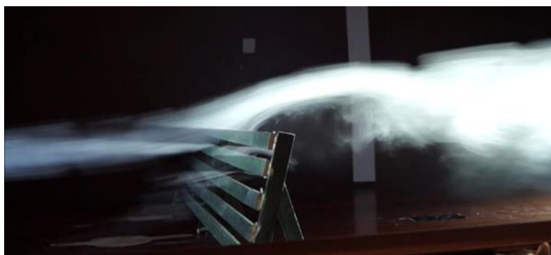
Figur 6: Bilde fra forsøkene i vindtunnelen. Vindens bevegelse synliggjøres med hjelp av røyk (Henriksen, Johansen, Hatten og Birkelid, 2019).
