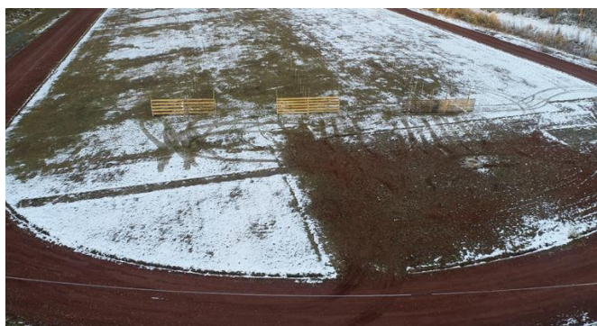
Figur 9: Utplassering av snøgjerder i Vålådalen, der gjerdene ble festet i trestolper som ble slått ned i bakken.
