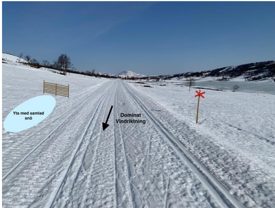
Figur 16: Viser hvordan en kan bruke snøgjerder ved langsgående vind i forhold til skiløypa eller alpinløypa.
