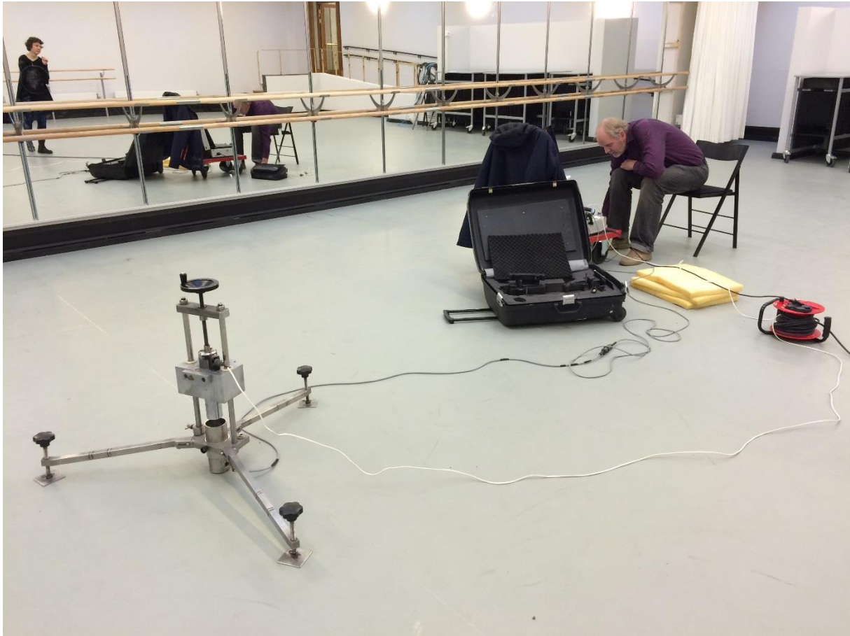
Figur 5 Fra målingene på dansegulv i West End Studio, Margarinfabrikken, Stavangergata 42, 5. etasje.
