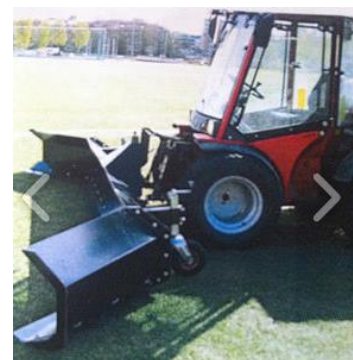
Brøyteskjær Arbeidsbredde: 400 cm Leverandør: Lier Traktor www.liertraktor.no
